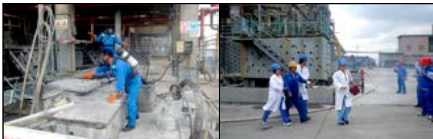
●倒槽操作人员在现场佩戴空呼进行倒槽操作
